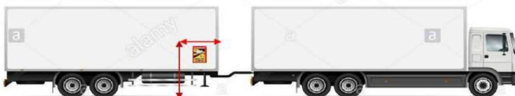
Dans le premier mètre de la partie carrossée avant à une hauteur entre 0.9 et 1.5m du sol
