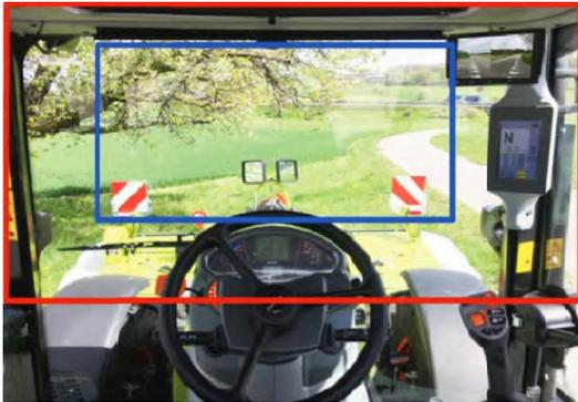
Der Führer oder die Führerin muss, bei einer Augenhöhe von 0,75 m über der Sitzfläche, ausserhalb eines Halbkreises von 12,0 m Radius die Fahrbahn frei überblicken können. (VTS Art. 71a<sup>1</sup>)
