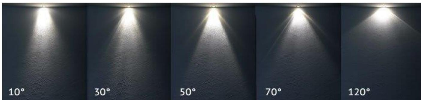
Die volle Lichtkraft wird nur im Zentrum des Kegels erreicht. Je weiter man nach aussen geht, umso mehr nimmt die Helligkeit des Lichts ab. Alles, was mit 50 % der Lichtstärke beleuchtet wird und damit im sogenannten Halbwertswinkel liegt, zählt zum Abstrahlwinkel. Der Halbwertswinkel entspricht also dem Abstrahlwinkel. Im äusseren Bereich des Lichtkegels, dem sogenannten Feldwinkel, beträgt die Lichtkraft nur noch 10 %. Dieser Winkelbereich ist nicht mehr Teil des Abstrahlwinkels.
